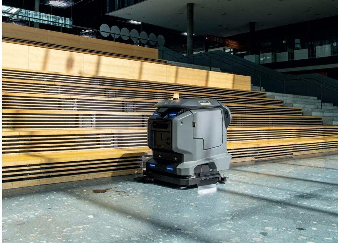
Grâce à une puissante batterie lithium-ion de 160 Ah, une technologie à brosse-rouleau avec fonction de prébalayage, une brosse latérale et une largeur de travail de 55 centimètres, la puissance de nettoyage de KIRA B 50 est tout à fait comparable à celle d'une autolaveuse aspirante classique.
