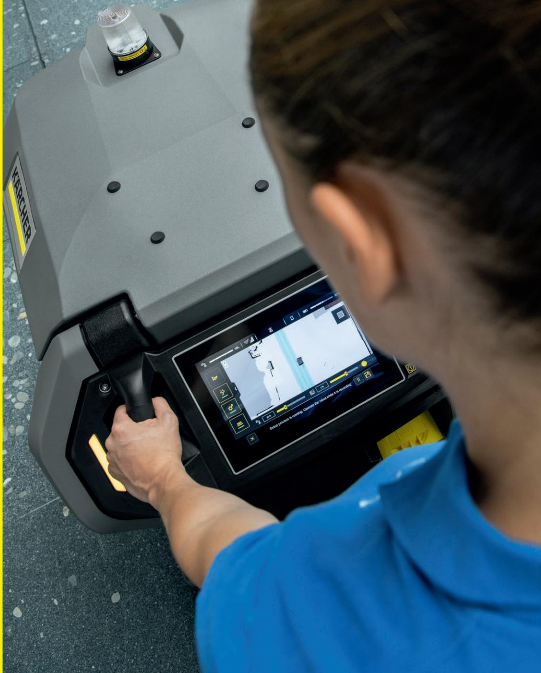
L'afficheur n'affiche que les commandes utiles pour la tâche en cours, pour plus de simplicité, de clarté et de sécurité. Même l'environnement détecté par les capteurs peut être visualisé sur une carte pendant le paramétrage, ce qui permet de suivre à tout moment et avec précision les éléments détectés par le robot de nettoyage et les zones déjà nettoyées.
