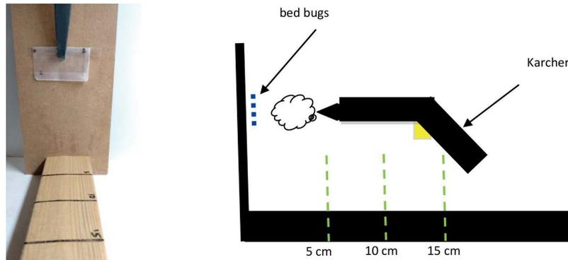
(左)試験対象のトコジラミを袋に入れ、木板に設置 (右)実験では、スチームの噴射位置を対象物から5cm、10cm、15cmの3つのパターンにわけ、それぞれの結果を測定
