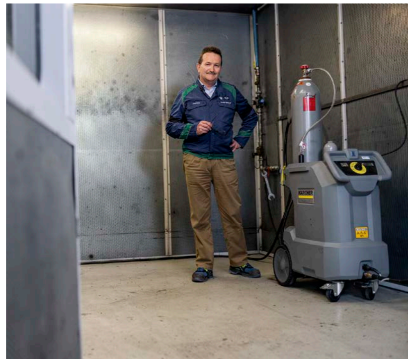
Das Trockeneis wird vom L2P-Gerät beim Reinigen aus CO 2 erzeugt. Das hat Alfred Weber und sein Team überzeugt.
