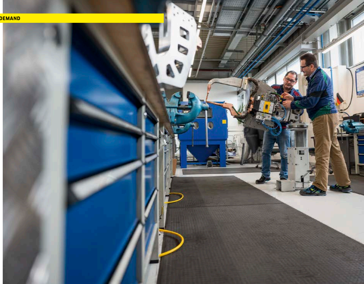
Wenn die Punktschweißzangen in die Instandhaltung kommen, werden sie zunächst geprüft.
