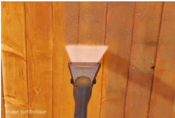
Pour le test en laboratoire, une méthode de test en plusieurs étapes a été appliquée. En plus du test sur des plaques colorées qu'il fallait nettoyer, le nettoyage a également été réalisé sur de véritables lames en bois altérées par le temps. La distance de nettoyage optimale qui en résulte a été transposée à une largeur de nettoyage mesurable à l'aide d'un capteur de force de jet. Cela a permis d'attester de la puissance de nettoyage supplémentaire de l'eco!Booster.
