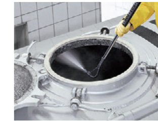
フレキシブルランス ノズル先端の角度を20°から140°まで変えることができます。通常ノズルでは届きにくい側面や裏面などの洗浄が行えます。
