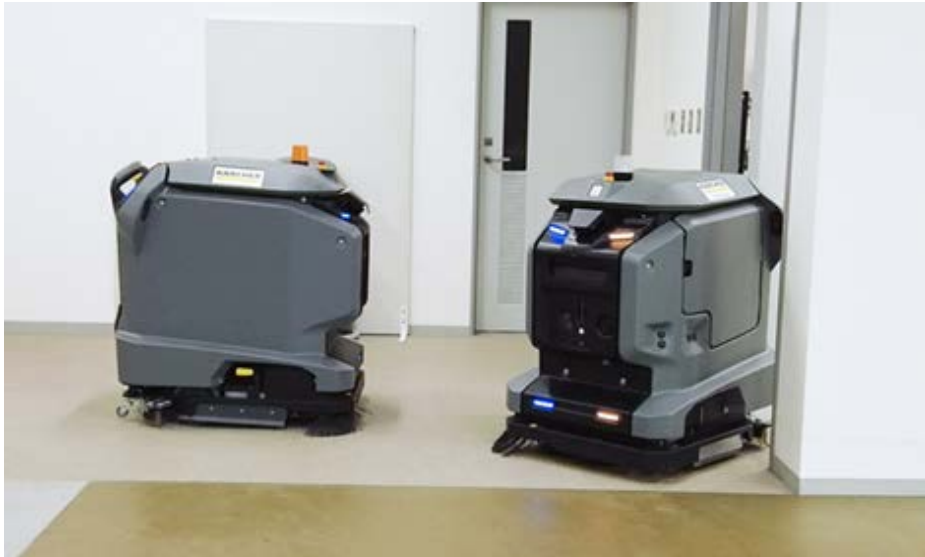
ROBO-HIによるロボットの群管理。「KIRA B 50」1機が部屋を出るまで、もう1機が待機する様子
