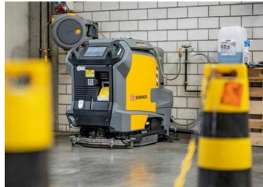
KIRA B 50 an der Dockingstation: vollautonomes Arbeiten durch selbstständiges Entleeren des Schmutzwassers, Wiederbefüllen mit Frischwasser und Laden der Batterie.
