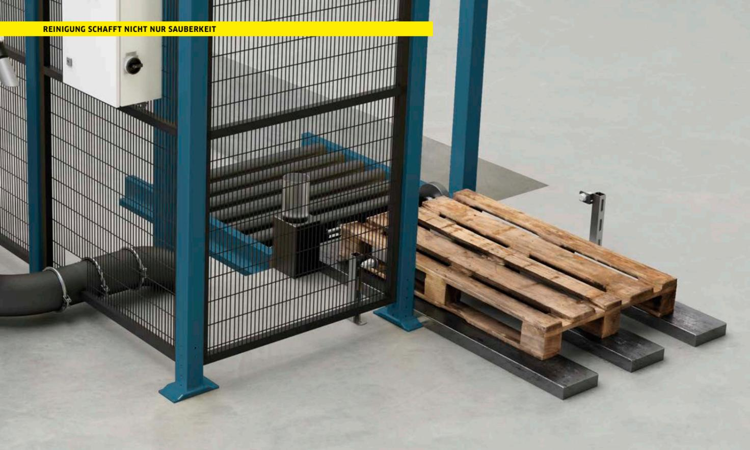
Über eine Zuführung wird die Palette ins Lager geleitet.
