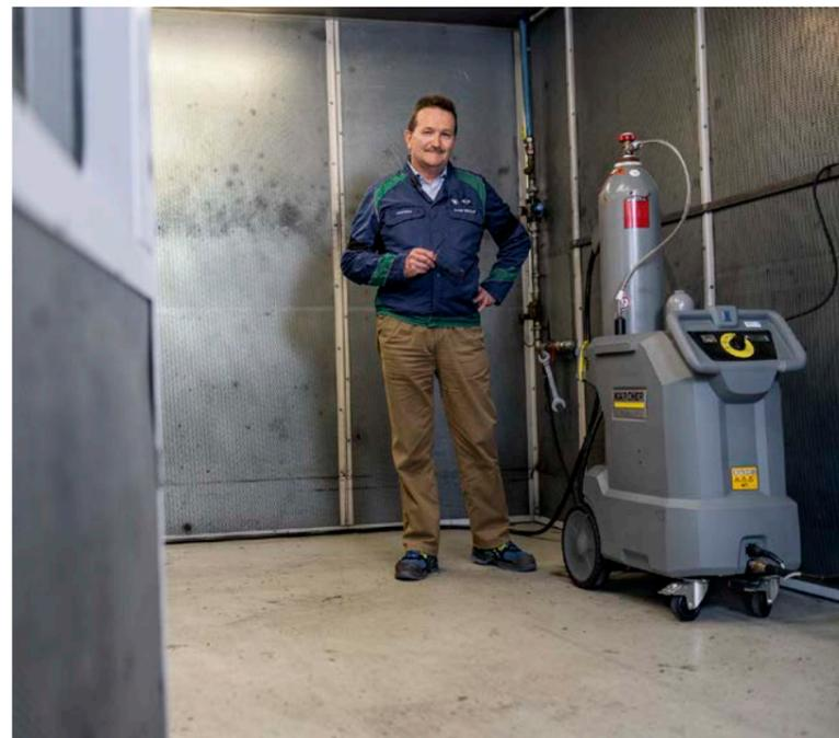
Das Trockeneis wird vom L2P-Gerät beim Reinigen aus CO<sub>2</sub> erzeugt. Das hat Alfred Weber und sein Team überzeugt.
