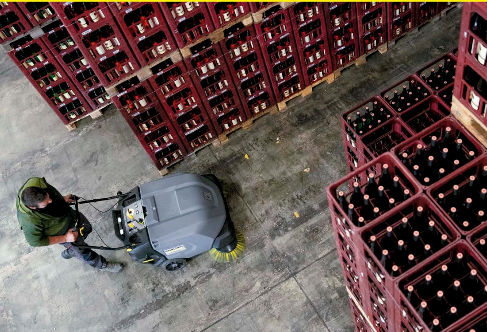
**4 Bodenreinigung mit handgeführten Kehr- und Kehrsaugmaschinen**
