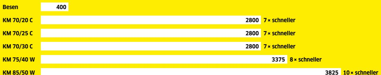
Flächenleistung einer Kehrsaugmaschine im Vergleich zu Arbeitskraft mit einem Besen.
