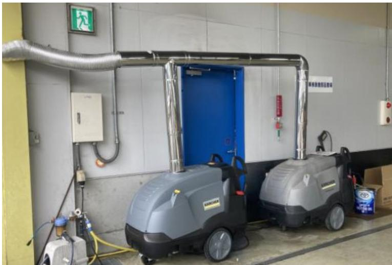
お客様からのヒアリングをもとに『HDS 10/19 M』を2台連結し、高温水を安定して供給できる仕組みを構築し、洗車工程に取り付けました。手作業の湯かけ洗浄が自動工程となったことで、花粉除去にかかる時間の短縮と作業者様の負担が大幅に軽減されました。作業者様の負担が大幅に軽減されただけでなく、洗浄品質の均一化や高い洗浄効果にもご満足いただけました。
