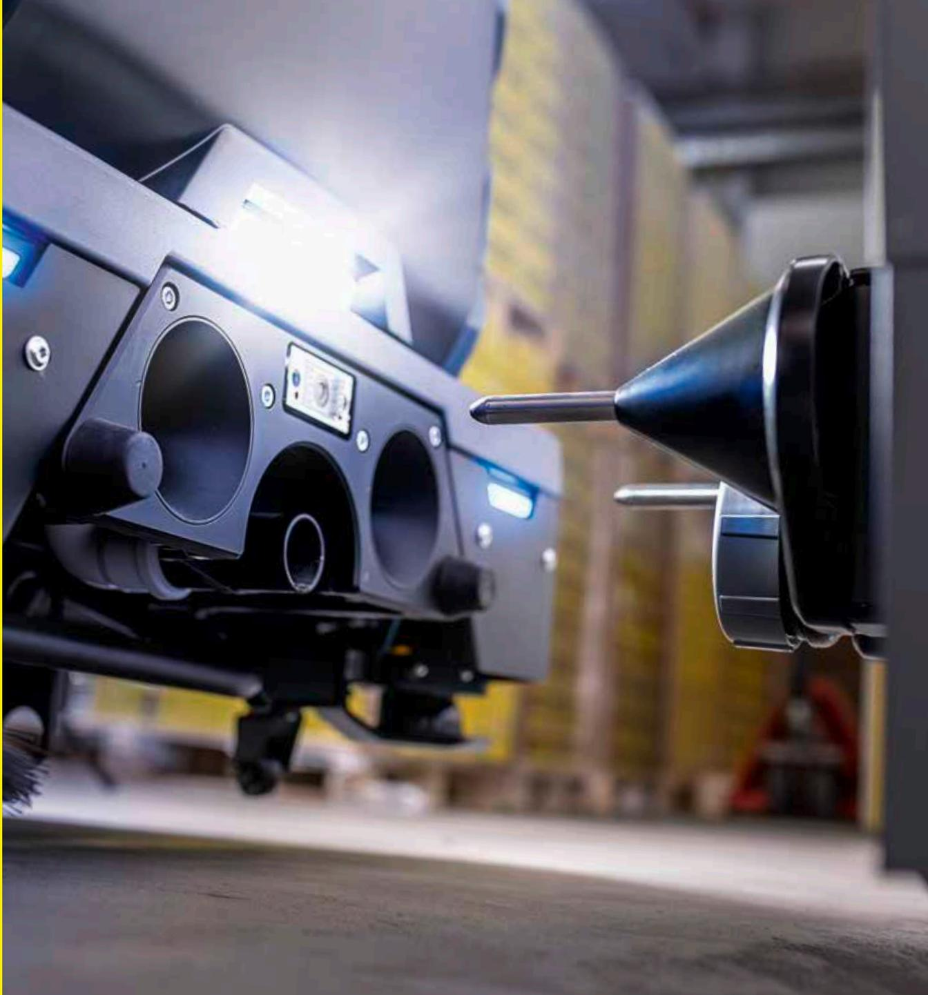
El resto funciona de manera completamente automática según las especificaciones del usuario; KIRA B 200 se desplaza sola a la estación base según lo programado, repone agua limpia, lava y vacía el depósito de agua sucia, carga las potentes baterías de iones de litio y continúa limpiando siguiendo otra ruta.
