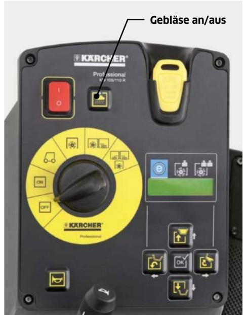
Kehrsaugmaschinen können auch bei feuchtem oder nassem Boden zum Einsatz kommen. Hierfür haben die Kehrsaugmaschinen die Möglichkeit entweder den Saugstrom durch eine Falschluffklappe zu unterbrechen oder die Saugturbine abzuschalten.
