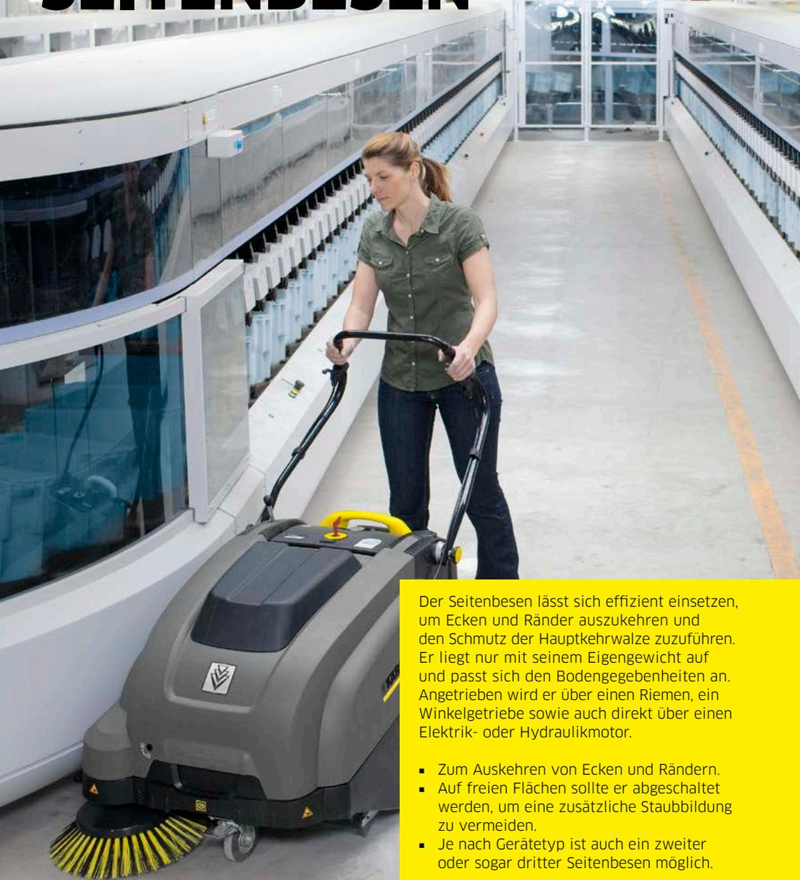
Der Seitenbesen lässt sich effizient einsetzen, um Ecken und Ränder auszukehren und den Schmutz der Hauptkehrwalze zuzuführen. Er liegt nur mit seinem Eigengewicht auf und passt sich den Bodengegebenheiten an. Angetrieben wird er über einen Riemen, ein Winkelgetriebe sowie auch direkt über einen Elektrik- oder Hydraulikmotor.
