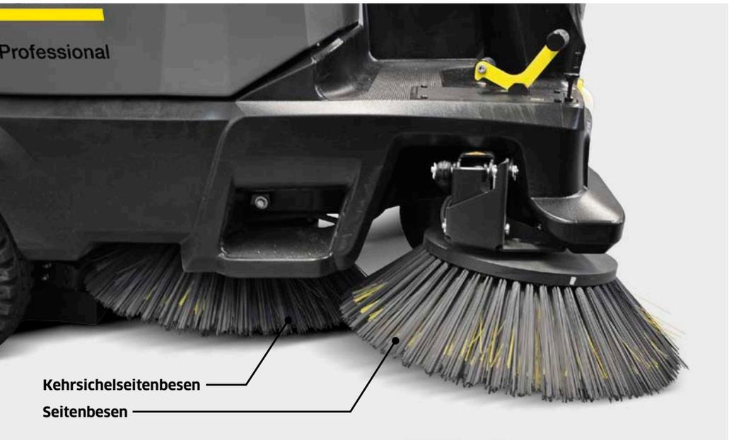
Abhängig vom Bautyp, liegt die Hauptkehrwalze geschützt in der Hinterachse des Geräts. Durch die große Distanz zum Seitenbesen, kann hier ein zusätzlicher Kehrsichelseitenbesen angebaut werden. Dieser liegt zwischen Hauptkehrwalze und Seitenbesen.
