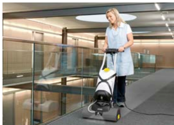
Aufsprühen und Einarbeiten des CarpetPro Teppichreinigers iCapsol RM 768 (6 %ig) mit der BRS 43/500 C.
