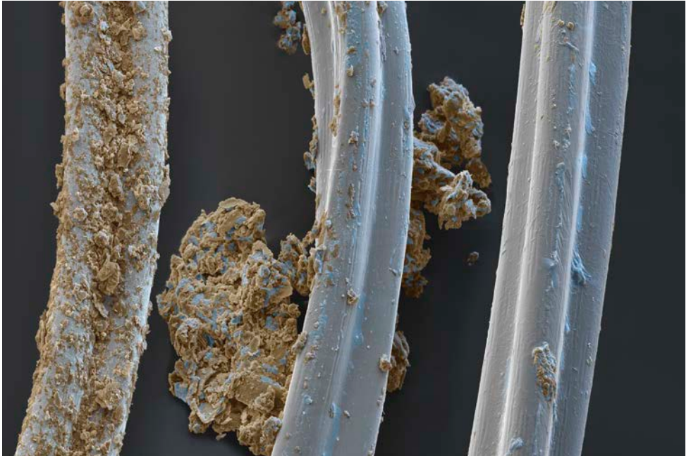
Links: verschmutzte Teppichfaser vor der Reinigung Mitte: eingekapselter Schmutz an Teppichfaser Rechts: saubere Teppichfaser nach dem Trockensaugen
