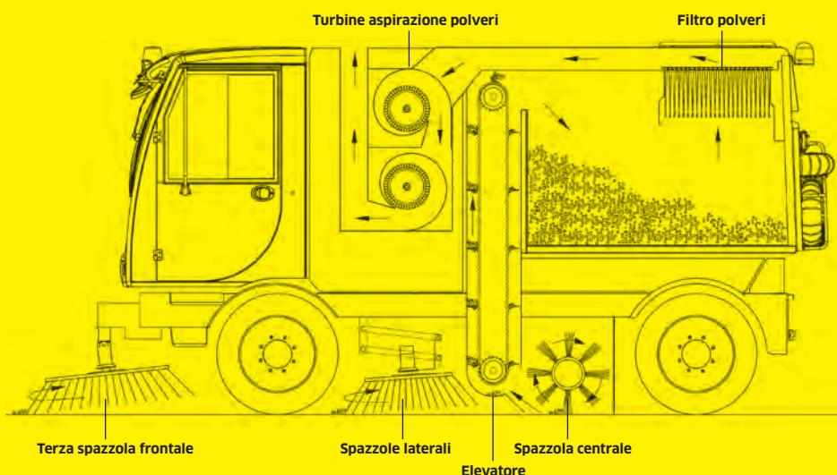
La raccolta combinata meccanica / aspirante / filtrante garantisce il caricamento potente e veloce di qualsiasi tipo di rifiuto urbano, sabbia, foglie, ghiaia e detriti di grandi dimensioni. Un efficace sistema di aspirazione ottimizza la raccolta di polvere e materiali leggeri. Il sistema di filtrazione, costituito da una batteria di filtri in poliestere, cattura il particolato fino a PM1 in tutte le condizioni operative, evitando l'emissione di inquinanti in atmosfera.
