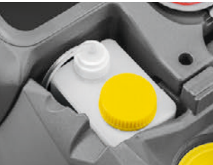
洗浄剤自動希釈機能【DOSE (ドーズ)】 洗浄剤を清水タンクに入れずに、設定した希釈にあわせてブラシヘッドに直接ポンプで届けます。清水タンクは水だけで汚さずきれいなままです。
