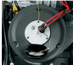
排ガス温度モニター 安全にご使用いただくために、異常温度を検知した場合は機械を停止させる機能を備えています。
