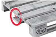
Ein Klotz fehlt oder ist so gespalten, dass mehr als ein Nagelschaft sichtbar ist.
