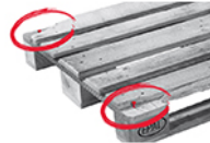
Ein Boden- oder Deckbrett ist so abgesplittert, dass mehr als ein Nagelschaft sichtbar ist.
