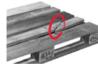
Ein Brett ist quer oder schräg gebrochen.
