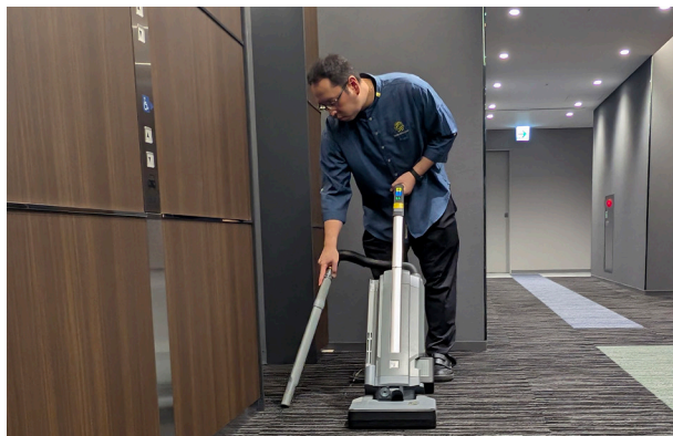
機能性に富んだアップライトバキュームは、ハンドノズルを標準装備。細かいところも除塵することができる
