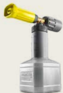
Skumdyse Basic Præcis dosering med tre forskellige doseringsventiler (1, 2, 4%). Beholderstørrelse 1 liter Art. nr. 4.112-053.0 350-600 l/t Art. nr. 4.112-054.0 700-800 l/t Art. nr. 4.112-055.0 800-2500 l/t
