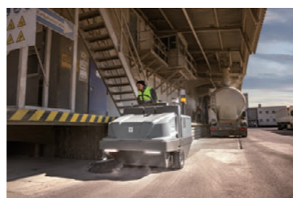
メインブラシが路面のゴミを効率良くダストコンテナに巻き上げます。
