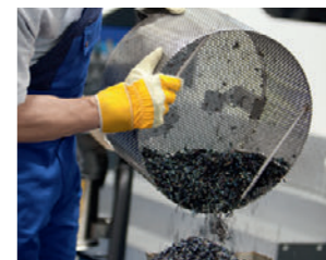
金属屑と切削油の分別が容易 <IVR-L モデル>
