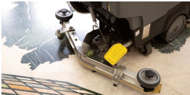
前方のディスクパッドで洗浄した水を、後方のV型スクイージーが集めて吸い込むため、拭き取りは不要。水残りもなく、ヒールマークも楽に落とせる
