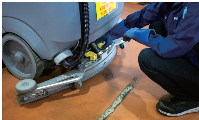
スクイジーの追従性に対する評価は高い。乾燥時間も短く、転倒リスクが軽減できる
