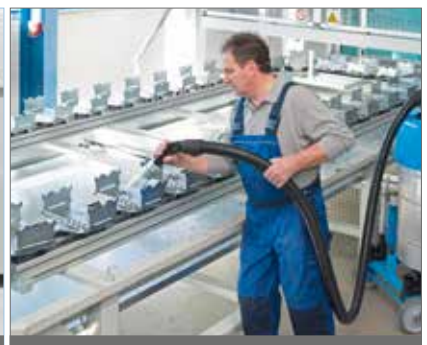
Aspiration de copeaux et de fluides d'usinage lors de la maintenance des machines et installations
