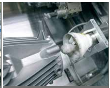
Suceur issue de l'impression 3D pour des applications particulières
