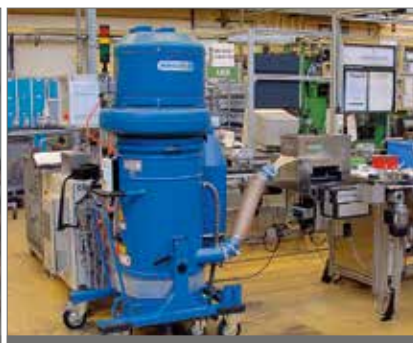
Dépoussiéreur intégré dans une ligne de fabrication
