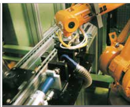
Sueur pour l'aspiration ponctuelle de résidus de fraisage
