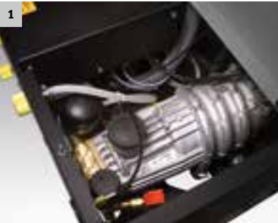
1 Watergekoelde 4-polige elektromotor Lange levensduur. Hoger rendement.
