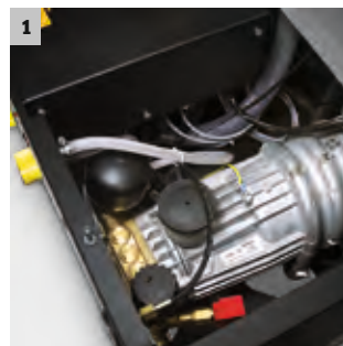
1 Wassergekühlter 4-poliger Elektromotor
