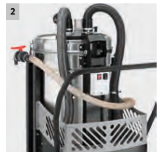
2 elektronisch gesteuerte Tangentialgebläse
