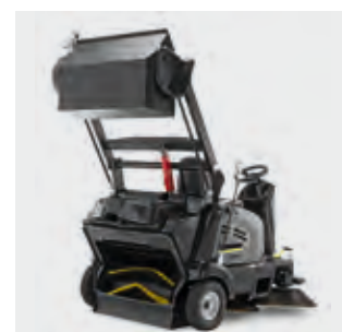
Hochentleerung Komfortable hydraulische Entleerung bis 1,55 Meter. Der Kehrgutbehälter kippt nach hinten weg und schützt den Anwender vor unnötiger Staubbelastung. Kein Kontakt mit dem Kehrgut.
