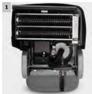
1 Schwebend gelagerter Bürstenkopf mit gegenläufigen Walzenbürsten
