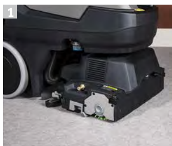
1 Rullo. Sostituzione senza attrezzi. Attacco utensile manuale.
