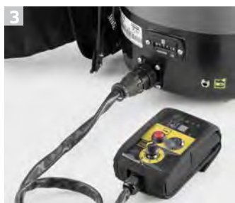
3 Comando remoto. Accensione/spegnimento e regolazione portata detergente.
