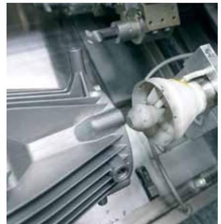
Düse im 3-D-Druck für besondere Absaugaufgaben
