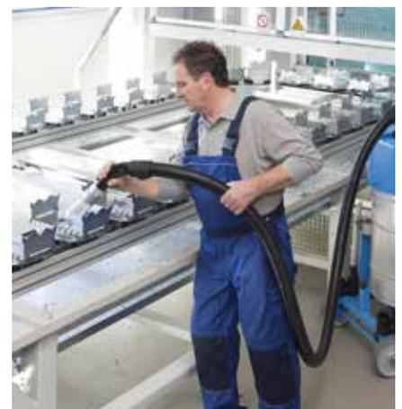
Späne- und Kühlschmierstoffabsaugung bei der Maschinen- und Anlageninstandhaltung
