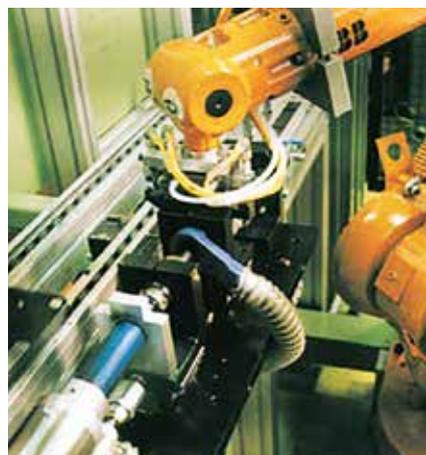
Ringler Saugdüse zur punktuellen Absaugung von Frässpänen
