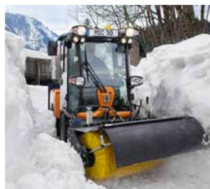
MIC 50, Frontkehrmaschine
