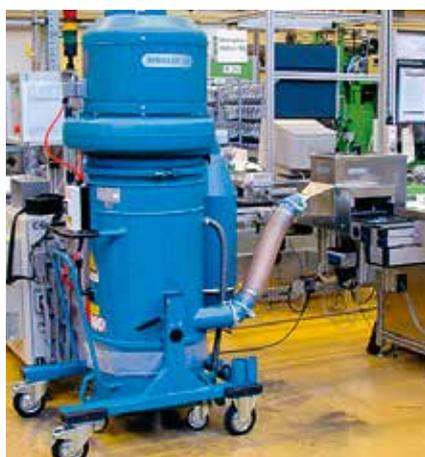
Entstauber in Fertigungslinien integriert
