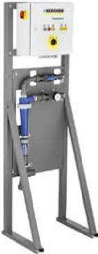
Die Wasserrecycling-Anlage WRP Car Wash für Pkw-Waschanlagen mit Hydrozyklon hat eine Durchflussleistung von bis zu 3000 l/h. Die Anlage reduziert den Frischwasserverbrauch um bis zu 85 %.
