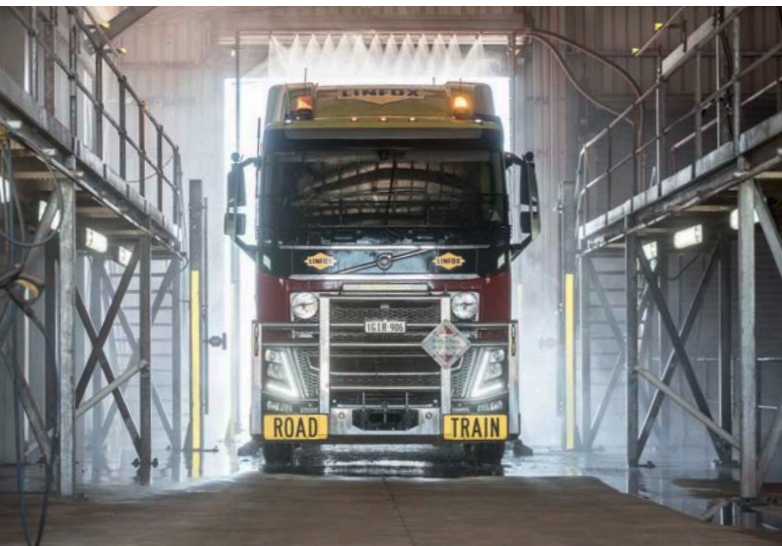
Die Road-Train-Waschanlage ist eine einzigartige Sonderanfertigung. Sie reinigt die gewaltigen Lastwagen in einem vierstufigen Prozess.
