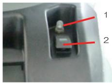
ブレーカーを押してください。 スイッチを押してください。 1 ブレーカー 2 スイッチ
