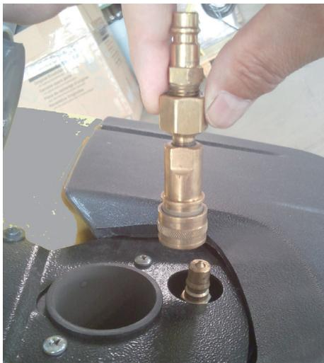
アクセサリホース挿入口カバーを開けてください。付属のカップリングを差し込んでください。
