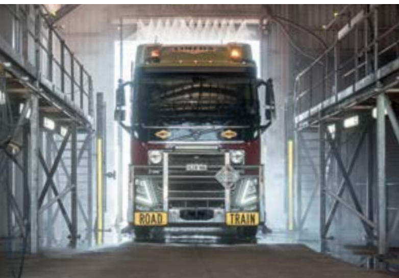
公路列车清洗系统专门针对公路列车研制，采用独特的设计，分四段清洗这种巨型卡车。
