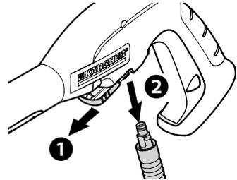
高圧ホースを取り外す場合は、**①**留め具を引き出してから**②**高圧ホースを引き抜きます。留め具は、3本線が入っている部分を親指と人差し指で挟み、押しながら**①**の方向に引き出してください。
