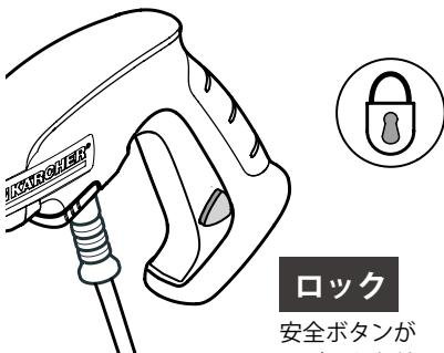
ノズルの取り付け・取り外しの際は、トリガーガンの安全ボタンをロックし、誤作動を防止してください。
