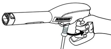
ノズルを取り外し、トリガーガンのレバーを握って、ポンプの残留圧力と残水を抜いてください。
