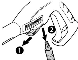
高圧ホースを取り外す場合は、**①**留め具を引き出してから**②**高圧ホースを引き抜きます。留め具は、3本線が入っている部分を親指と人差し指で挟み、押しながら**①**の方向に引き出してください。
