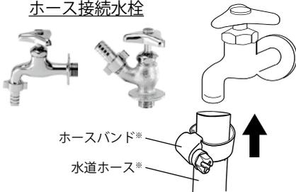
水道ホースを蛇口に差し込み、ドライバーを使ってホースバンドを固定します。
