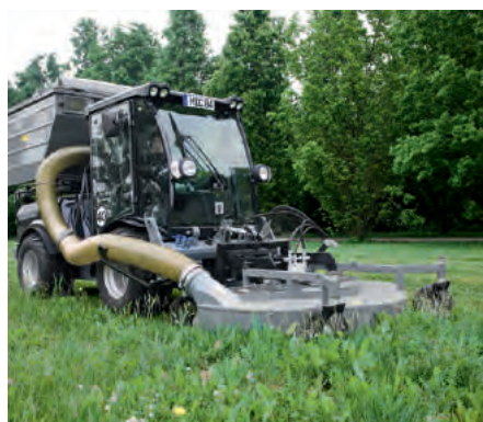
MIC 84, комбинирано косене изсмукване
