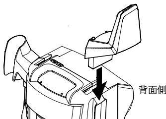
電源コードフックを本体に差し込み下に押し込んで固定します。
