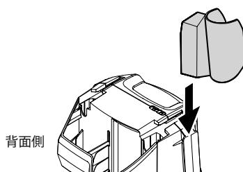
トリガーガンホルダーを本体に差し込み、止まるまで下に押し込んで固定します。
