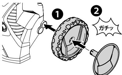
本体背面を下にし、横に倒します。2つある穴の背面側の方に①タイヤの穴を合わせ②留め具を押し込みます。ガチッと音がするまでしっかりと押し込んでください。取り付け後、本体を起こします。
