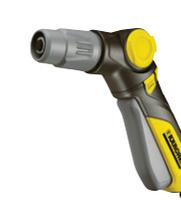
ノズル先端部を左右に回して散水パターン(ストレート~霧状)を調節可能。水量は黄色いレバーで無段階に調節できます。また、ヘッドの向きは180度変えることができます。
