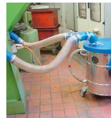
Prikladni za separiranje letećih iskri kao i ljepljivih, jako laganih i problematičnih procesnih tvari
