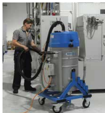
Usisavanje maziva za hlađenje prilikom zamjene
