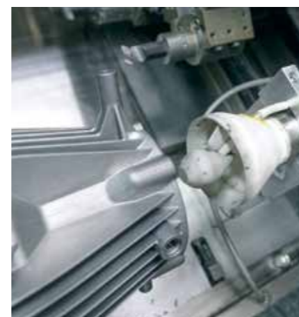
Mlaznica u trodimenzionalnom ispisu za posebne zadaje usisavanja
