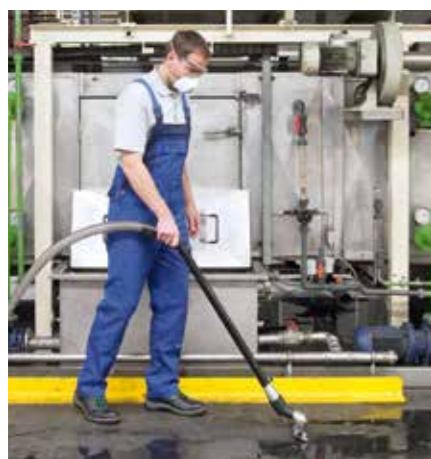
Usisavanje tekućina, emulzija i ulja kod čišćenja radionice
