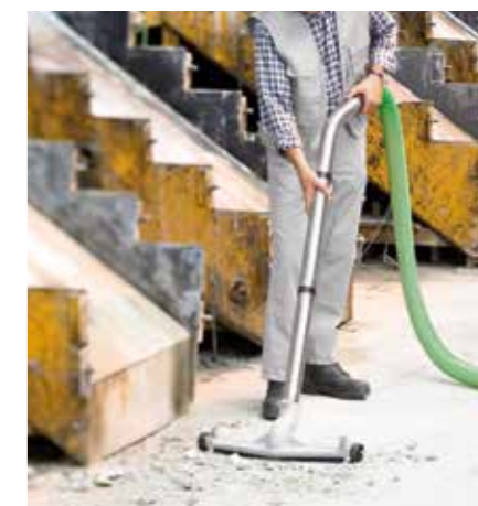
Usisavanje mineralnih ostataka, npr. betona
