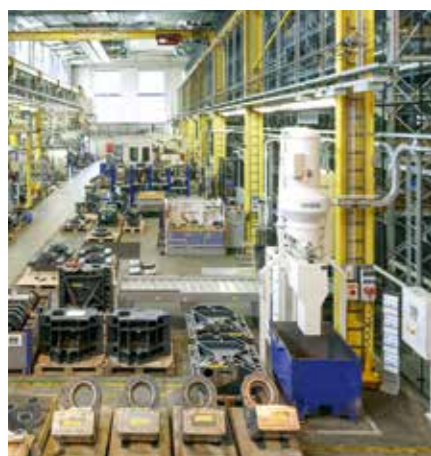
Glavni usisni uređaj kao sustav za više mjesta u metaloprerađivačkoj industriji
