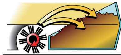
巻き上げ方式で効率良く清掃
