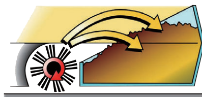
巻き上げ方式で効率良く清掃
