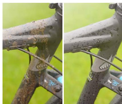
► Dank des Mitteldrucks bleiben auch Schläuche usw. an Ort und Stelle; hier werden keine Schäden durch den Wasserstrahl verursacht.
