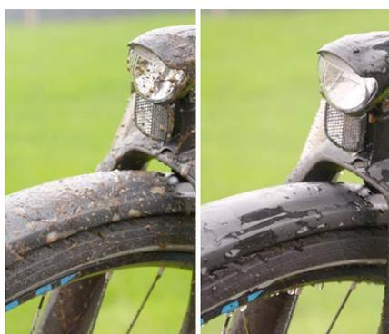
► Mit der Flachstrahldüse lassen sich Schlammgespritzer leicht abspülen; und das, ohne den empfindlicheren Komponenten des Fahrrads zu schaden.
