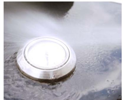
Dank des Mitteldruckes lassen sich auch empfindlichere Stellen säubern, ohne Schäden herbeizuführen (hier: Lack eines Grills).
