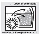
Efficacité : le principe de balayage permet de remplir à 100 % la cuve à déchets.
