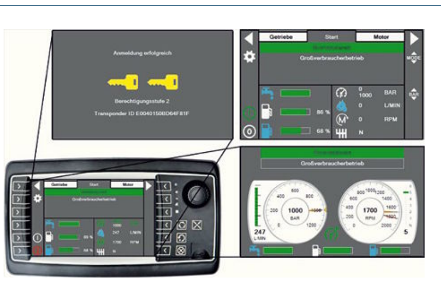
Abb. 4: Das Steuerungsdisplay zeigt übersichtlich den Maschinenzustand und alle Betriebsparameter.
