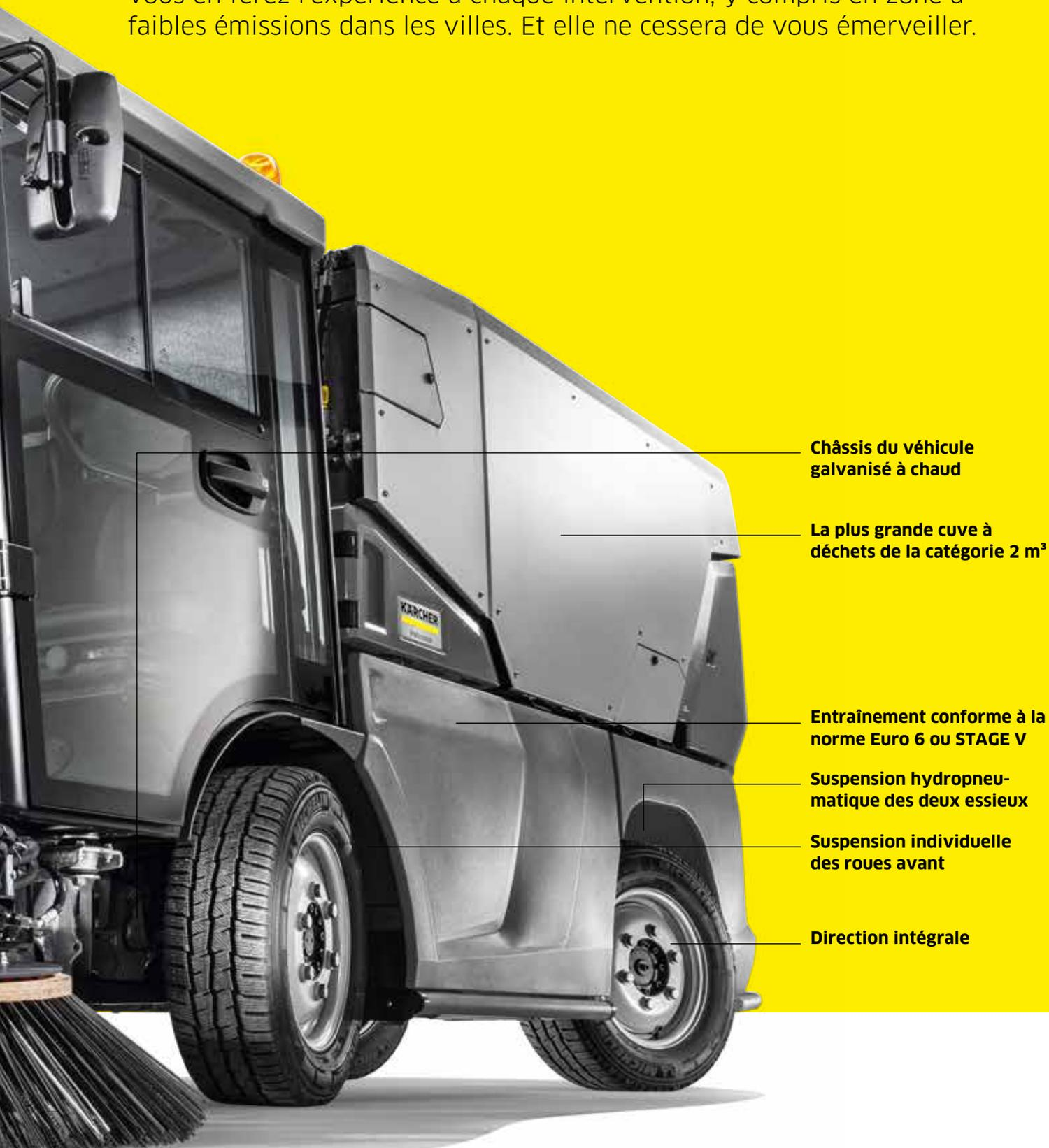
**Châssis du véhicule galvanisé à chaud**
