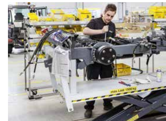
Nykonstruerad robust ram med integrerade hjulmotorer,
