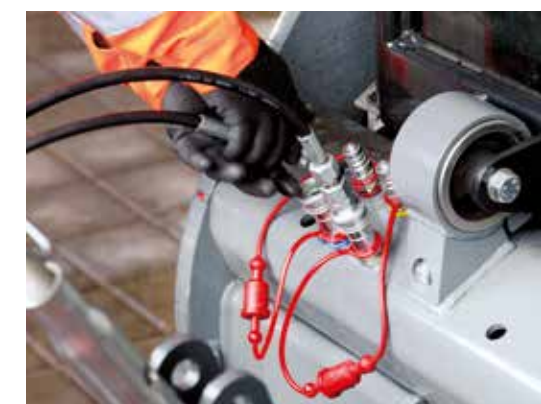
TransGiant är utrustad med lättåtkomliga hydraulanslutningar vid redskapsbyte.
