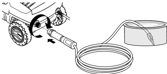
ため水を利用して高圧洗浄機を使用する場合は、まず「呼び水」を行います。呼び水を行う事で本体内部や自吸用ホース内の空気が抜け、高圧洗浄機に負担をかけずに使用することができます。
