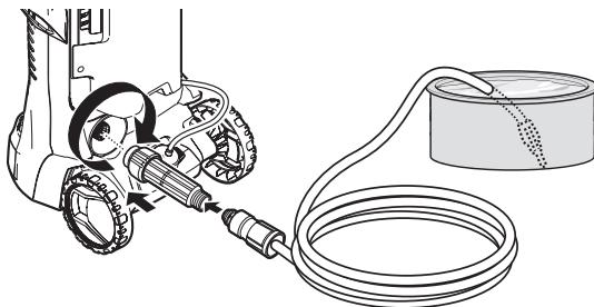
ため水を利用して高圧洗浄機を使用する場合は、まず「呼び水」を行います。呼び水を行う事で本体内部や自吸用ホース内の空気が抜け、高圧洗浄機に負担をかけずに使用することができます。
