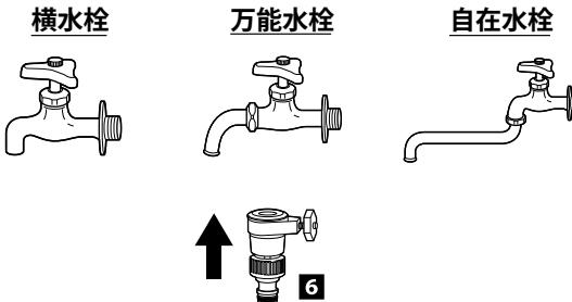
2 水道ホースに逆止弁付マルチコネクターを取り付ける
