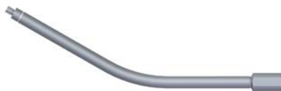
Lanze 30° 600mm 600bar IM30X1,5 - G 3/8DA Material-Nr.: 9.871-876.0
