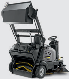
リフトアップできるコンテナで、ゴミの廃棄を効率良く
