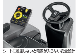
シートに着座しないと電源が入らない安全設計
