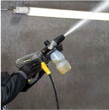
Raccordi extra per montare gli ugelli direttamente sulla pistola ed aumentare la maneggevolezza. I raccordi girevoli evitano che il tubo si attorcigli e servono anche per collegare le prolunghe tubo.
