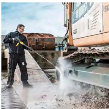
Gli ugelli rotanti di Kärcher combinano i vantaggi del getto puntiforme con quelli del getto a ventaglio. L'ugello gira a circa 4000 rpm per applicare la potenza del getto puntiforme ad un'area più estesa.
